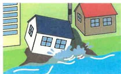
河岸の侵食による建物倒壊
